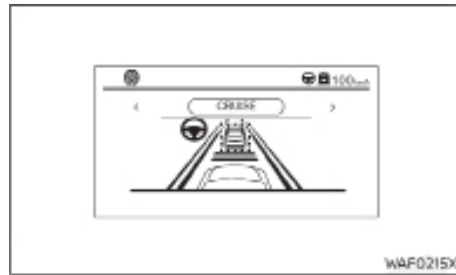
نمایش تنظیم سیستم هنگام شناسایی خودروی جلویی
